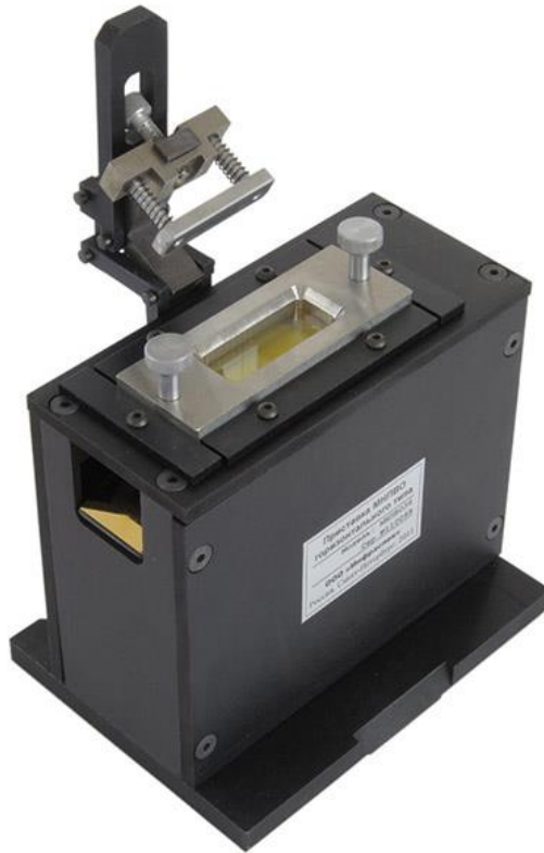
圖 6. 紅外線光譜儀的多重衰減全內反射附件
