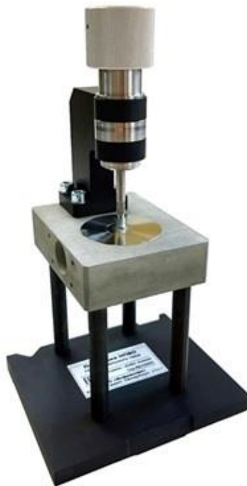
圖 7. 紅外線光譜儀的多重衰減全內反射附件。 鑽石配件
