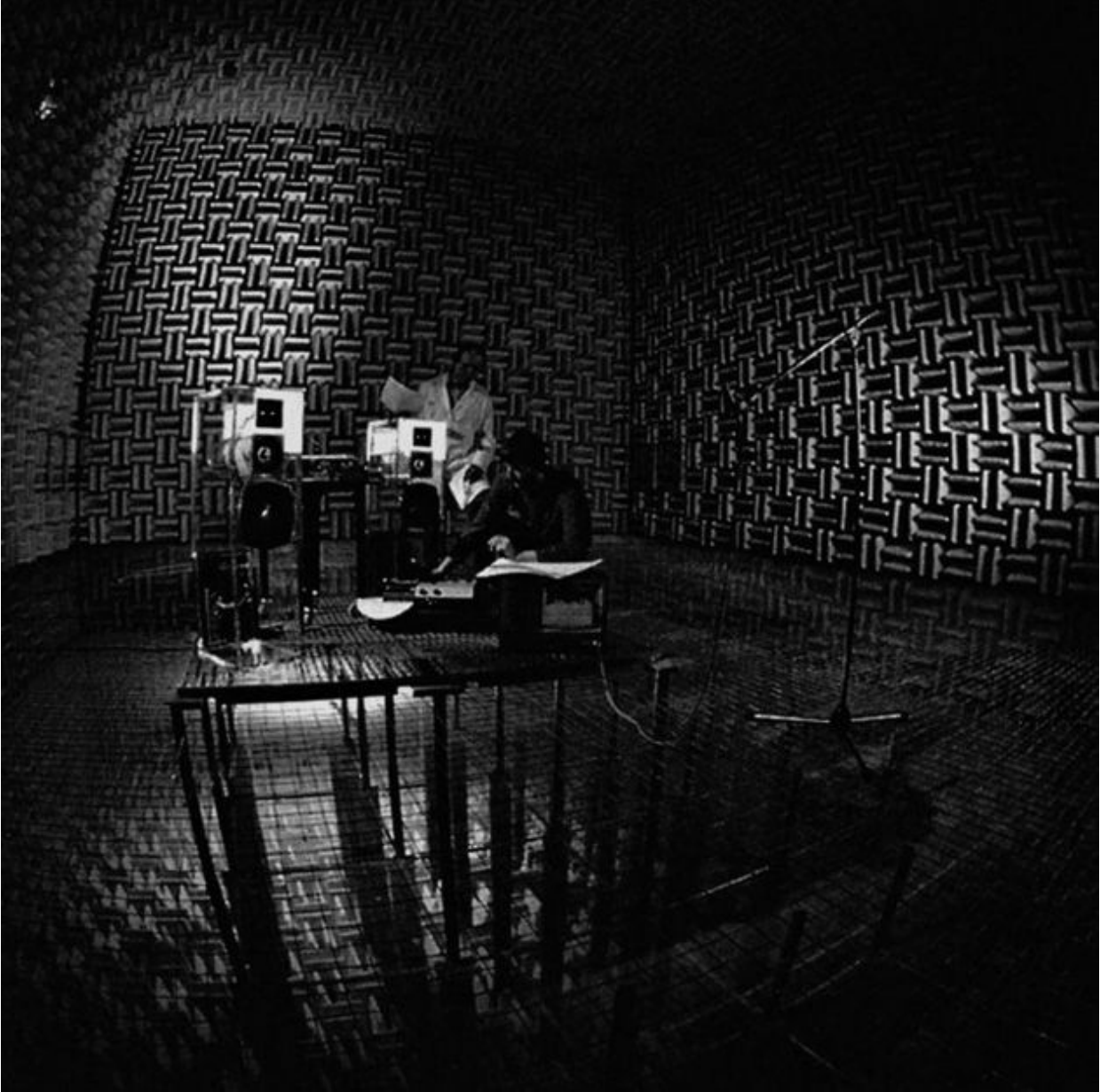
Low-reflection (soundproof) space at the Fraunhofer-Institut für Bauphysik, Stuttgart.
