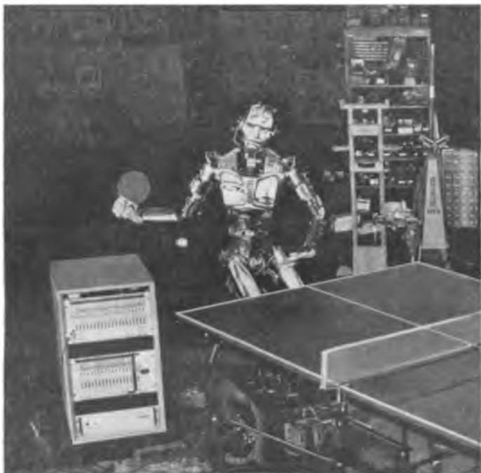
Робот, играющий в настольный теннис; фирма «Sarcos». Реагирует на мышечную активность своего визави.
